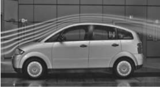
Dış akışta sınır tabakanın oluşumu
