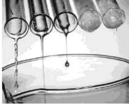
Viskozitesi yüksek olan akışkanlar akmakta zorlanır
